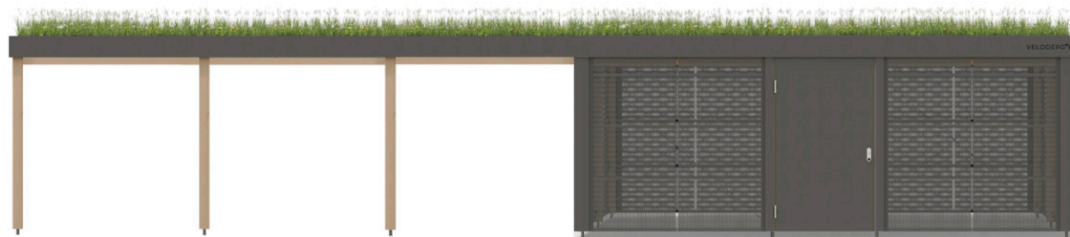
BSP. FASSADENBEKLEIDUNG LOCHBLECH
